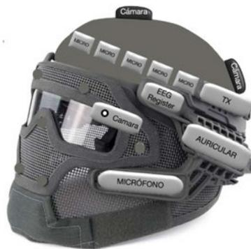
Figura 3: Casco con diferentes sensores
